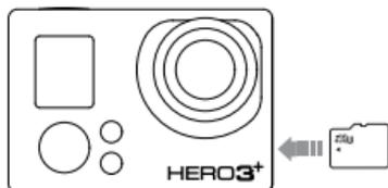
1. Stecken Sie die Speicherkarte mit dem Etikett zur Vorderseite der Kamera hin in den Kartensteckplatz.
