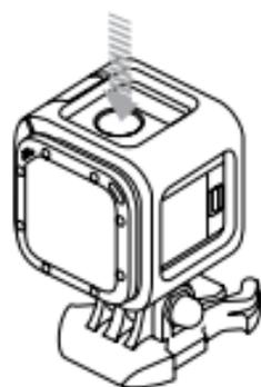
**專業提示：**將相機收入提袋或口袋內時，請將相機上下倒置放入相機外框（蓋住 **Shutter/Select (快門/選取)** 按鈕 [●]），以防止相機意外拍攝影片或相片。若要避免相機外框在相機表面留下痕跡，請將相機外框上的扣鎖保持開啟。
