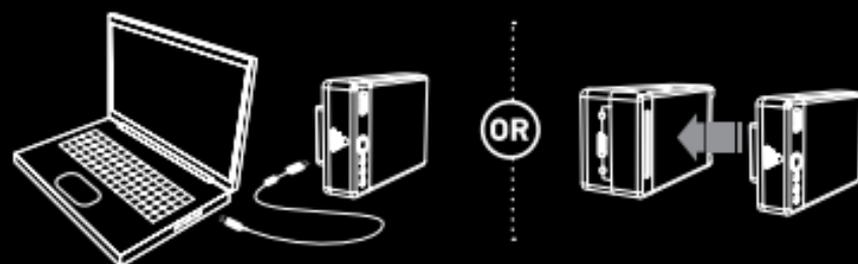
1. Den BacPack mit dem beiliegenden USB-Kabel an einen Computer oder ein beliebiges kompatibles Wand- oder Kfz-Ladegerät (Telefonlader usw.) anschließen.
