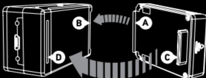
1. Das Hakenende des BacPac (A) in der Rille an der rechten Seite des Kameragehäuses (B) einhaken.
