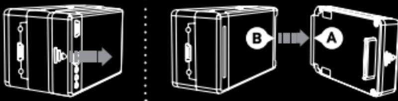
1. Zum Abtrennen aus dem HERO Bus-Port die durch Pfeil angegebene linke Seite des BacPac wegziehen.
