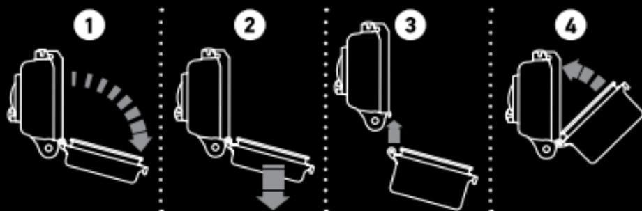
1. Die Rückseitenabdeckung des Gehäuses öffnen und nach unten hängen lassen.
